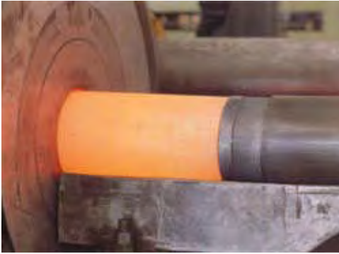
Resim 4.7: Bakır borunun haddede çekimi
