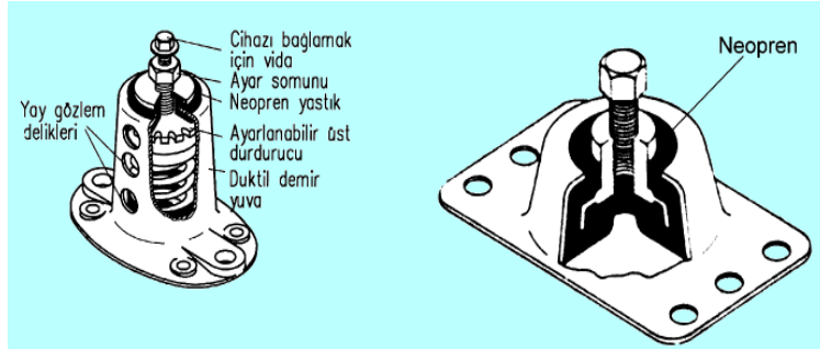
Şekil 5.1: Sismik sınırlayıcı titreşim alıcı ayak
