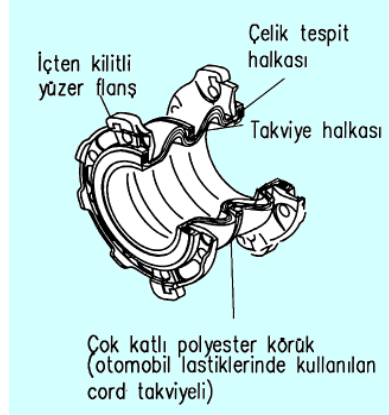
Şekil 5.6: Küresel kauçuk kompanzatör
